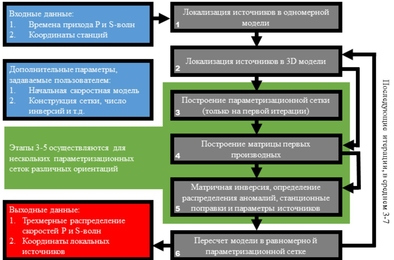
Рисунок 2.10 – Главная структура кода. Серые блоки показывают главные шаги кода; синий блок - входные данные: основные и параметры, которые вводит пользователь; красный блок – получаемые результаты; зелёная область – три объединённых этапа.
